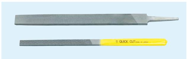
■従来のヤスリ刃の刃先を化学研磨加工によって、鋭利な刃物の刃先の様に加工し、凹部も懐が深くなっている為、硬化プラスチック、木材、軽金属等の目詰りを起こし易い材料に適しています。
